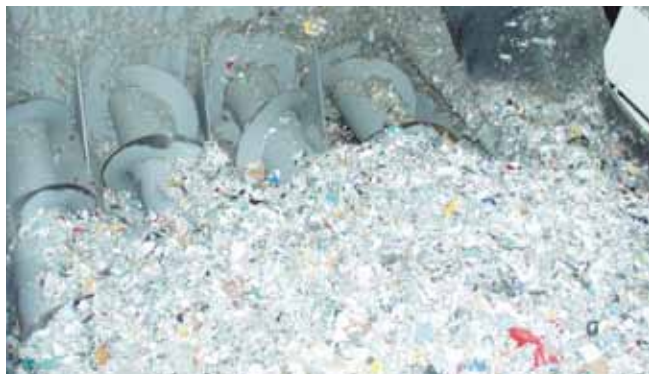
图 4: 处理坞站中的螺旋取料底板
